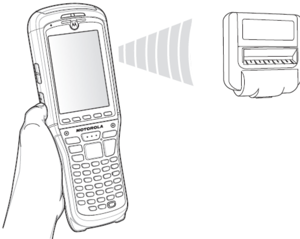
Рисунок 3-20 Выровняйте MC9500-K с устройством, оборудованным IrDA портом.
