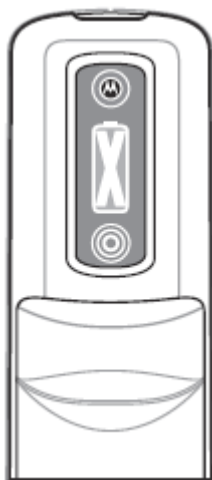
Рисунок 2-3 Индикация о некондиционности аккумулятора
